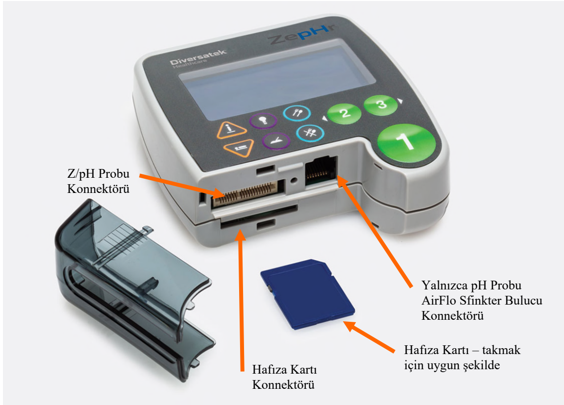
Şekil 2: ZepHr Kaydedici – Kapağı Çıkarılmış Üstten Görünüm
