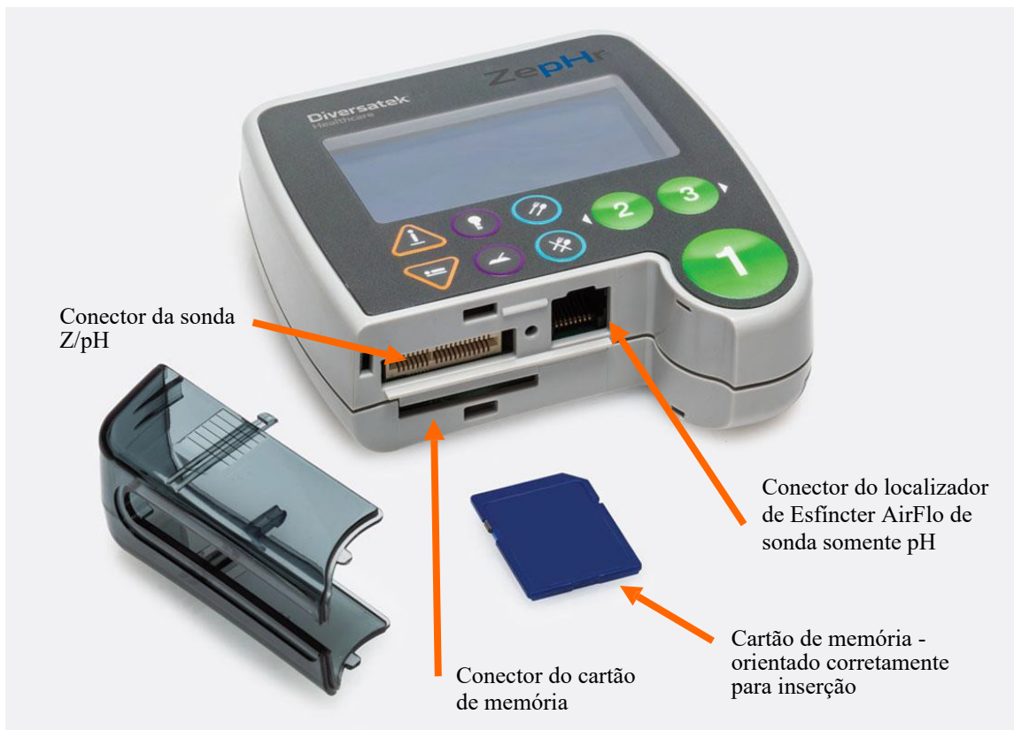
Figura 2: Gravador de dados ZepHr - Vista superior sem tampa
