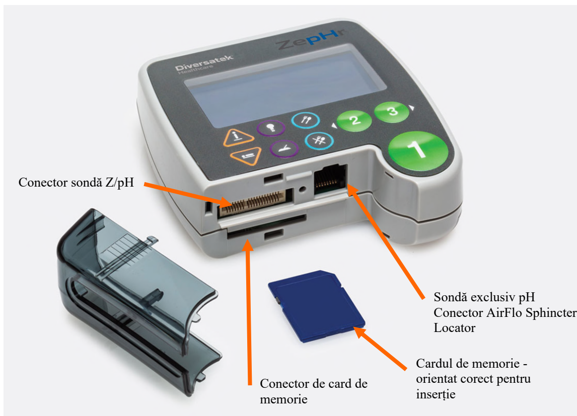
Figura 2: Recorderul ZepHr - Vedere de sus cu carcasa demontată
