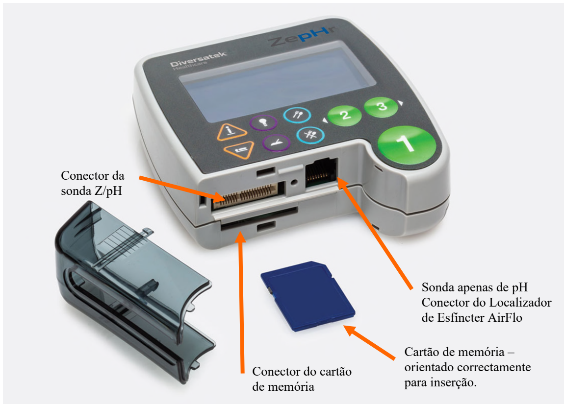
Figura 2: Gravador ZepHr - Vista superior com tampa removida
