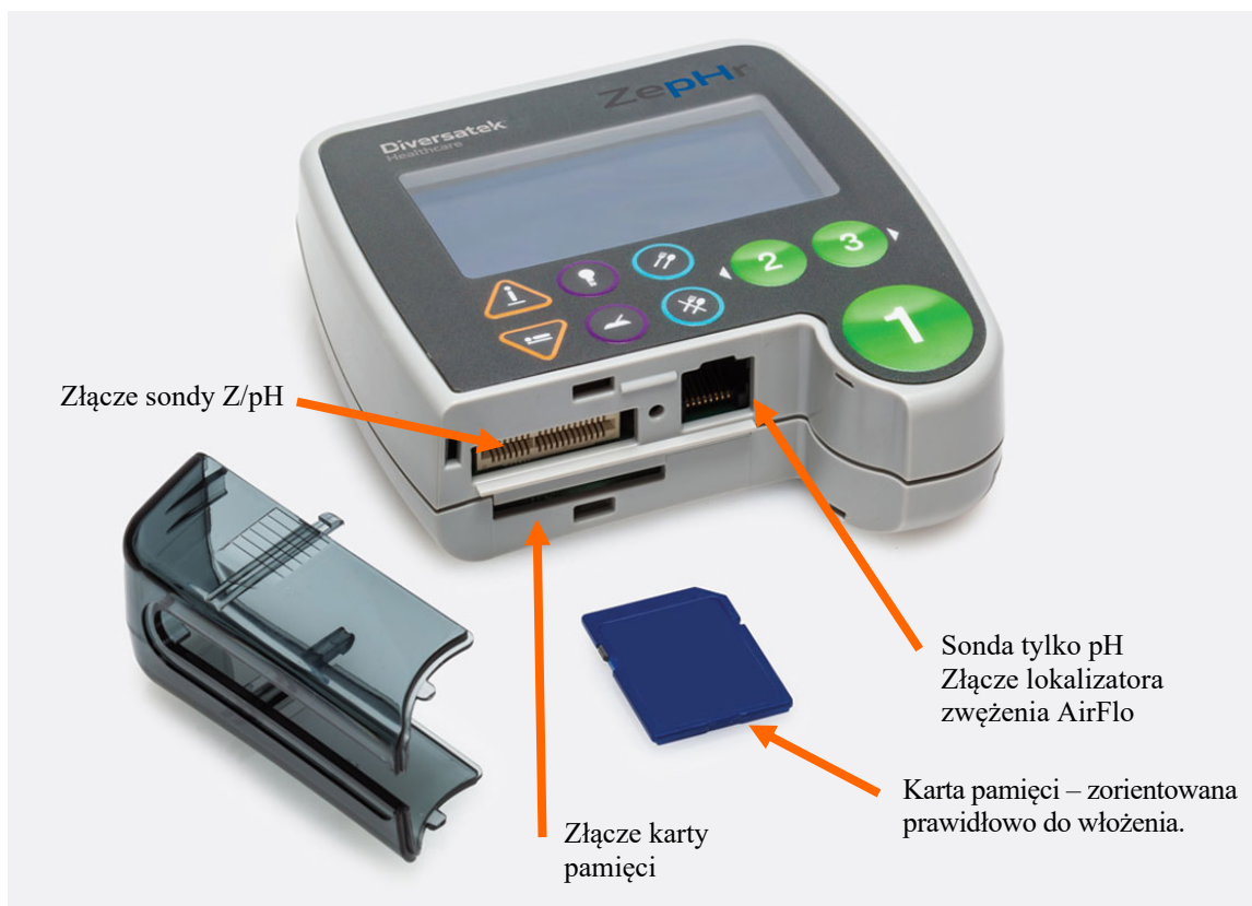
Rysunek 2: Rejestrator ZepHr – widok z góry ze zdjętą pokrywą
