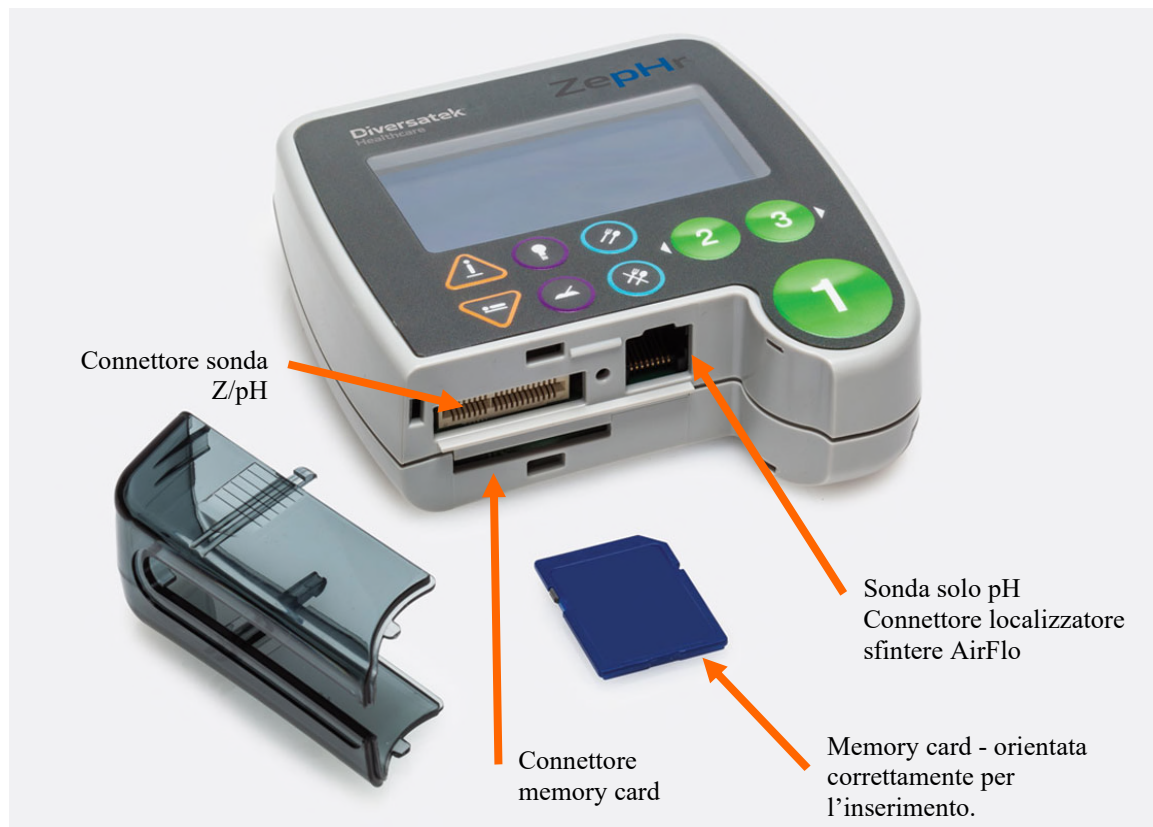
Figura 2: Registratore ZepHr – Sezione superiore con copertura rimossa
