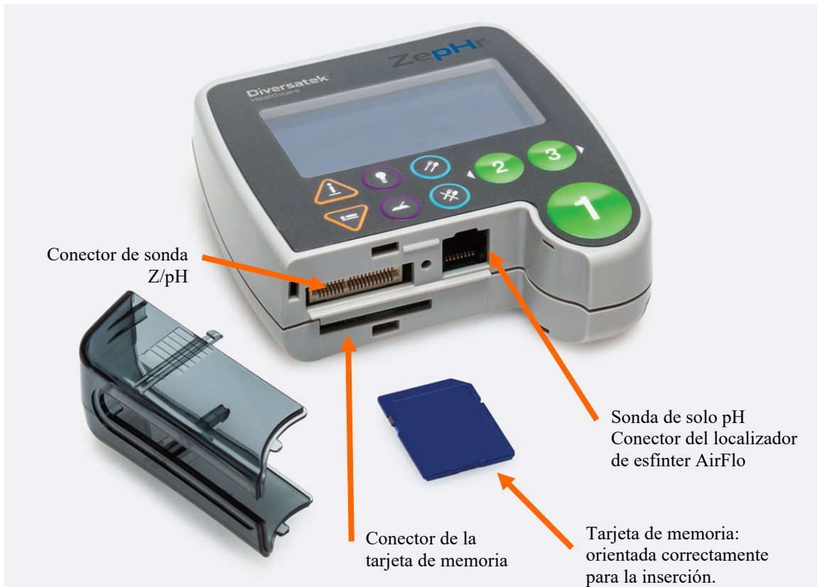
Figura 2: Grabador ZepHr – Vista superior con la cubierta retirada
