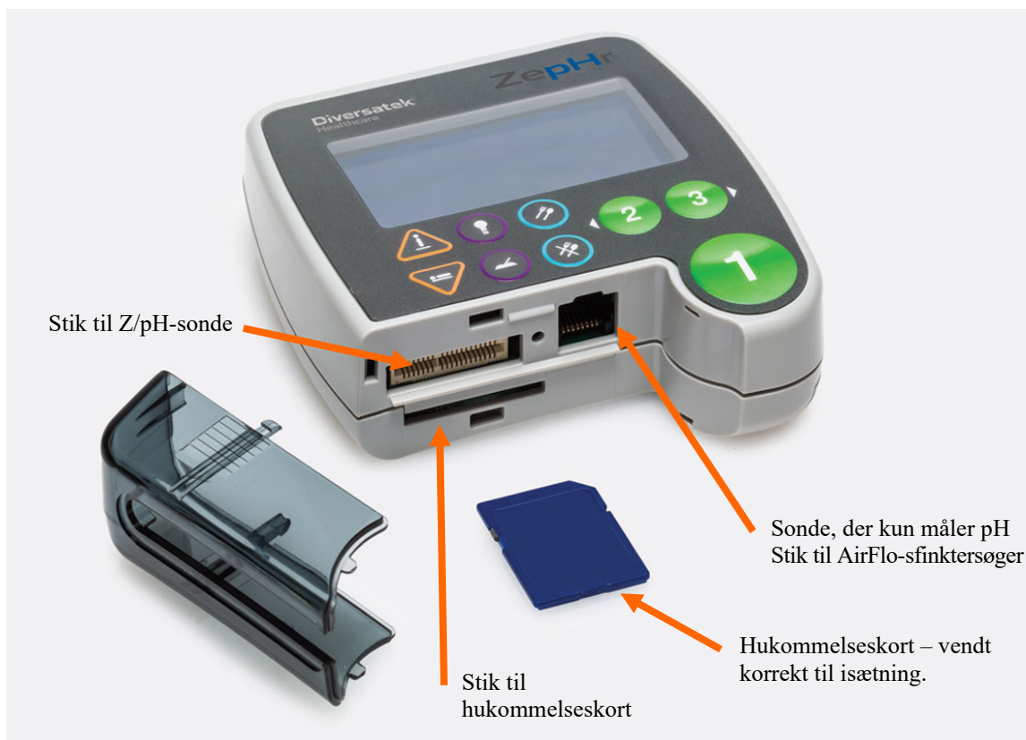
Figur 2: ZepHr-optager - set ovenfra med dæksel fjernet
