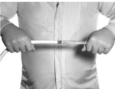
FIGURE 5. RETRAIT INCORRECT DE L'EMBOUT AMOVIBLE
