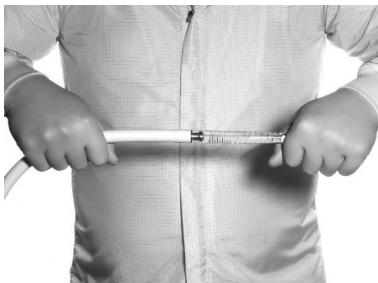
AFBEELDING 5. ONJUISTE VERWIJDERING VAN AFNEEMBARE TIP
