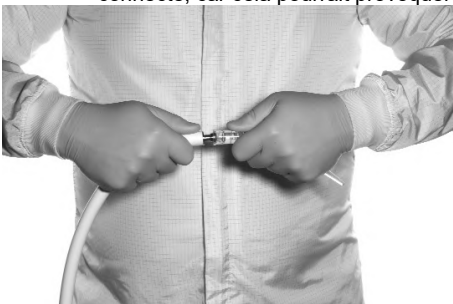
FIGURE 3. RACCORDEMENT DE L'EMBOÛT AMOVIBLE AU CÂBLE À FIBRES OPTIQUES
