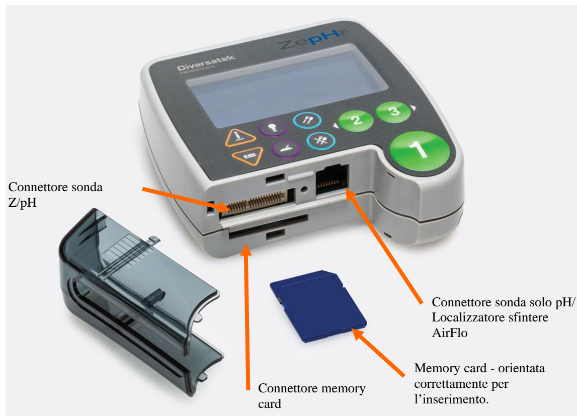
Figura 2: Registratore ZepHr - Sezione superiore con copertura rimossa
