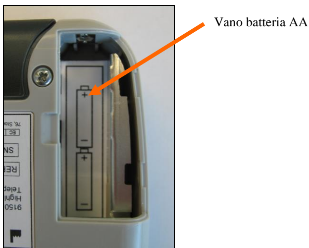
Figura 3: Registratore ZepHr – Sezione posteriore con copertura del vano batteria aperta
