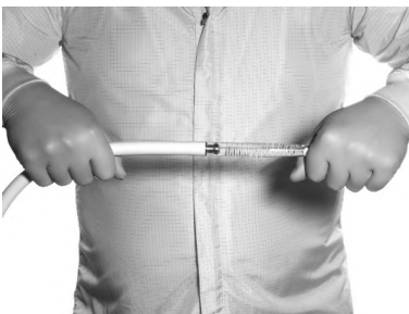
FIGURA 5. RETIRADA INCORRECTA DE LA PUNTA DESMONTABLE
